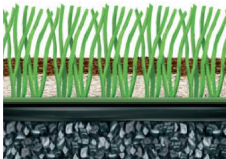
Σχ. 1. Τυπική τομή Ποδοσφαιρικού τάπητα τύπου έξι (6) πίνακα Α.6 EN 15330-1:2013-12 άνευ προκατασκευασμένου ελαστικού υποστρώματος
